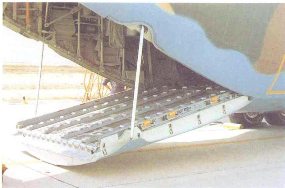
Fig. 3.—Rampa del portón trasero que facilita el acceso al interior de la aeronave.
