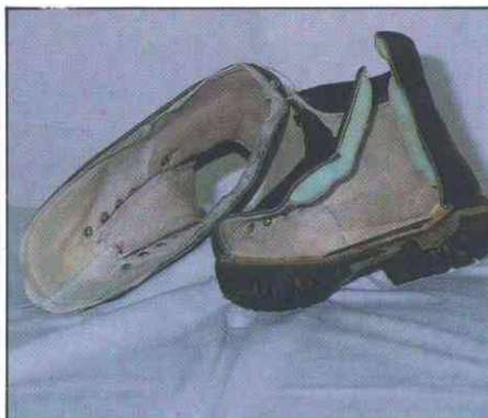
Figura 7.— Corte de la bota mostrando el forro.
