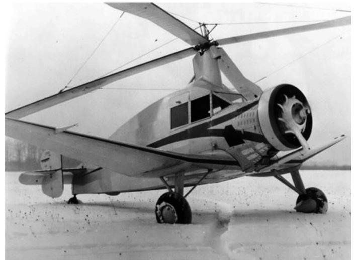
**Figura 2.** El modelo PA-19 fue el primer autogiro con cabina cerrada. Tenía un nuevo sistema de movimiento manual del eje para ajustar el rotor que le proporcionaba un vuelo muy estable. Imagen colección Stephen Pitcairn.
