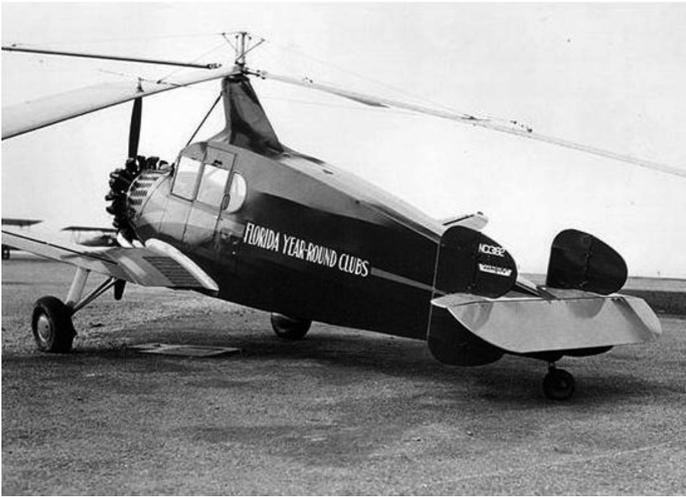
**Figura 3.** El modelo PA-19 era el autogiro más grande construido, la adaptación sanitaria era sencilla al poderse realizar una puerta para camillas en este lateral del fuselaje. Imagen colección Bruce H. Charnov
