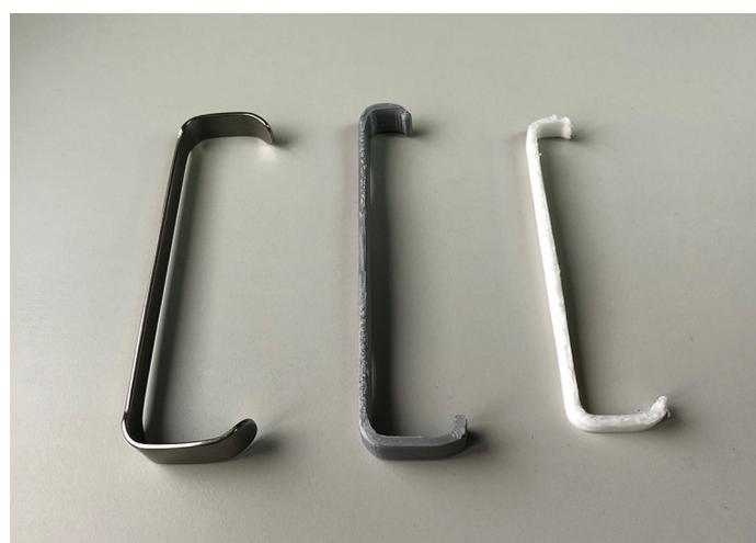
**Figura 2.** De izquierda a derecha, distintos separadores tipo Farabeuf en acero quirúrgico, en ABS y en PLA.
