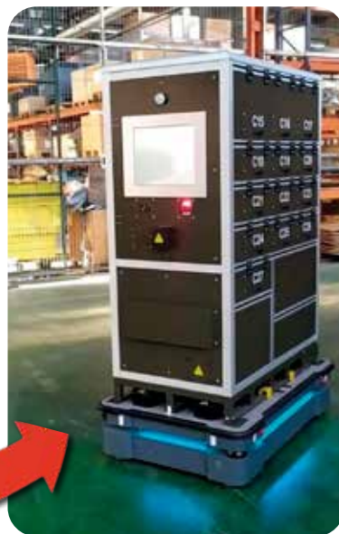
El robot AGV MiR500 se dirige al punto de carga, se sitúa justo debajo del armario y lo transporta hasta el punto de descarga
