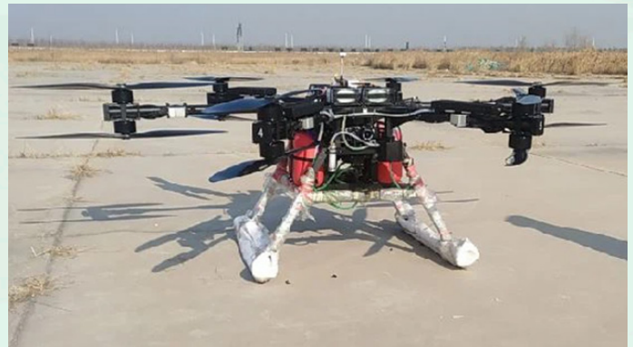
Dron de la empresa SAT con carga útil de 50kg, altura de vuelo de 1000m sobre el nivel del suelo, 40km de alcance y operable con vientos de 53 km/h.
