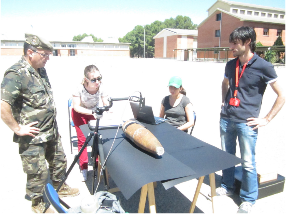
Figura 2. Adquisición de las firmas espectrales de un proyectil 155 mm
