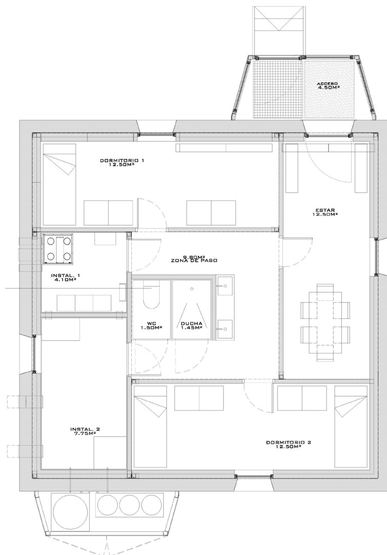
Imagen 4. Distribución en planta del prototipo ZEROENERGYMOD. Fuente: B+Haus
